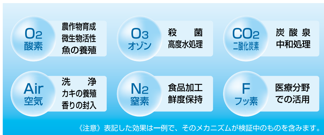
図2 ファインバブルに封入する気体とその機能
