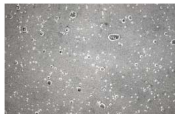
【上・中】ファインバブルを活用した『キューピーシェフスタイルマヨネーズ』のパッケージとマヨネーズ。業務用マヨネーズのラインナップのひとつとして多くのユーザーに使われている／【下】マヨネーズを拡大した様子。マイクロサイズのバブルが多く含まれていることがわかる。
